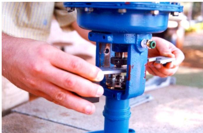
**4** - Aperte o parafuso allen de fixação das duas partes do suporte.
