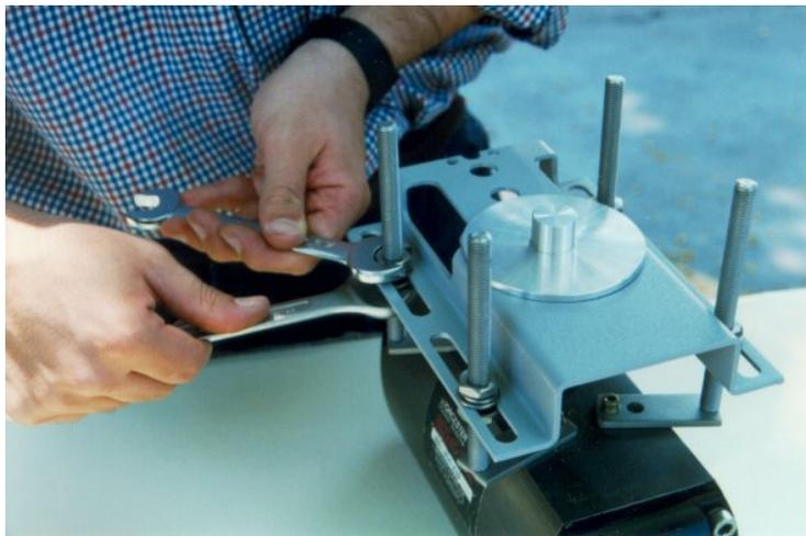
**11** - Remova o dispositivo centralizador e aperte o posicionador no suporte.
