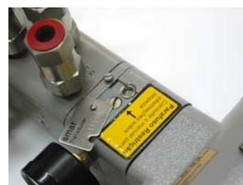
3. Remova o parafuso da restrição utilizando uma chave de fenda adequada;
