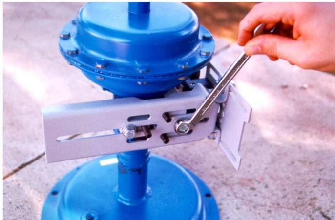
**11** - Monte posicionador na chapa de fixação apertando os parafusos allen. Se preferir, retire a chapa de fixação para facilitar a montagem.
