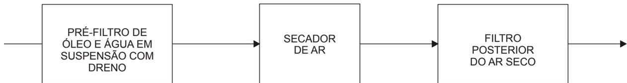
Figura 1.14 - Sistema de Condicionamento da Qualidade do Ar
