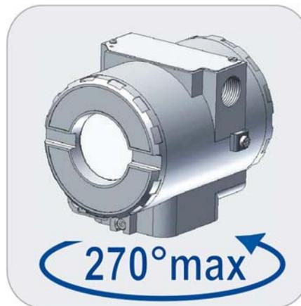
Figura 4.2 – Rotação do Transdutor
