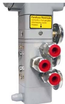
2. Com uma chave apropriada, remova a placa que protege o parafuso da restrição. (Novos modelos têm a placa posicionada do lado oposto ao transdutor).
