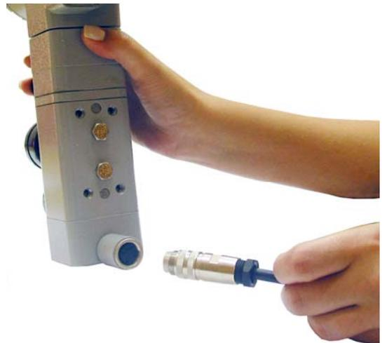
**Figura 1.20 - Conectando o cabo ao Posicionador**
